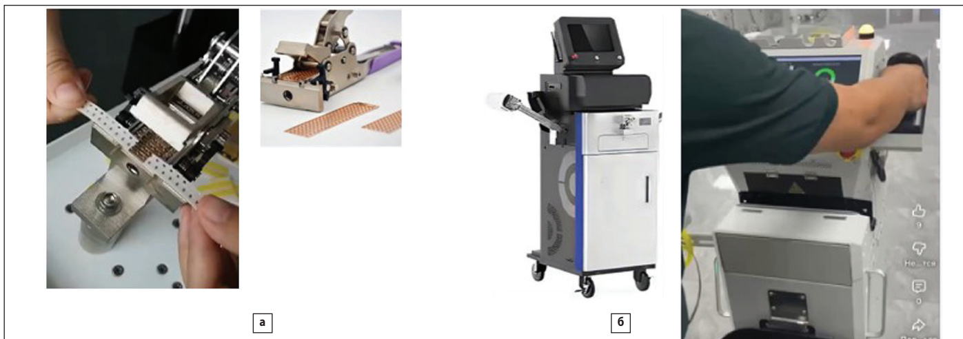
Рис. 10. Процесс срачивания лент: а) ручная процедура; б) автоматическая процедура
