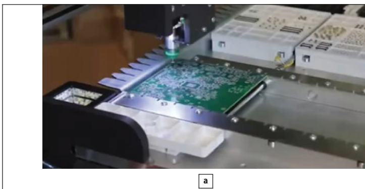
Рис. 13. Автоматический установщик компонентов российского производства «Сатурн»: а) процесс монтажа; б) внешний вид
