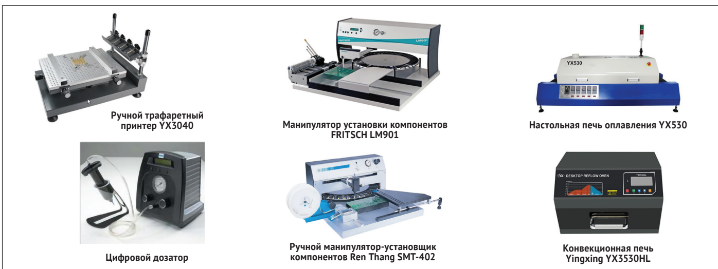
Рис. 3. Пример линии полуавтоматической сборки
