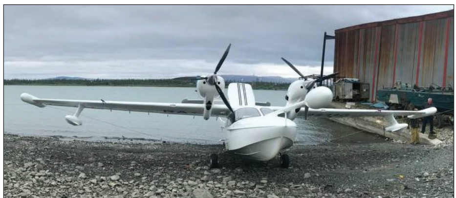
Рис. 4. Легкомоторный самолет Л-42М с установленной магнитоградиентометрической системой производства АО «НПП «Радар ммс»
