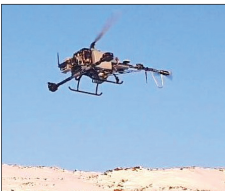
Рис. 3. БПЛА вертолетного типа АО «НПП «Радар ммс» во время выполнения магнитной съемки на Полярном Урале
