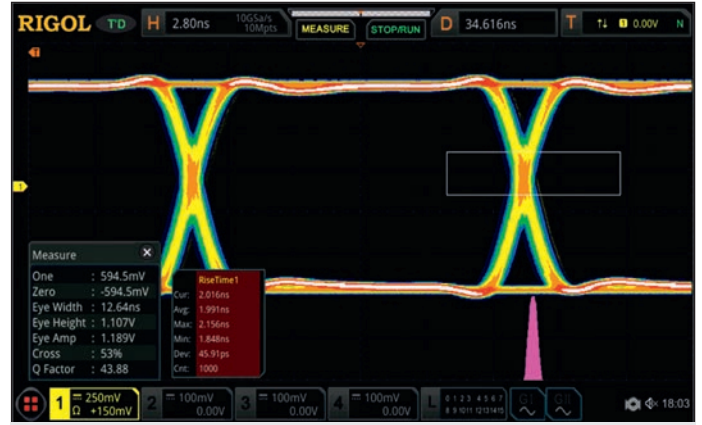
Рис. 10. Глазковая диаграмма после комплекса улучшений характеристик устройства
