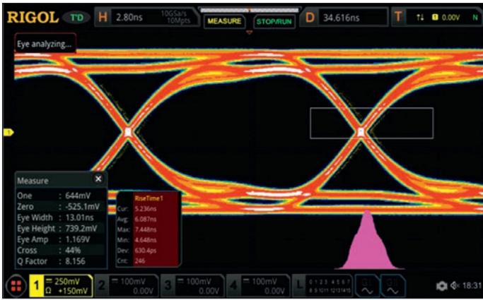
Рис. 9. Глазковая диаграмма с улучшенным шумоподавлением
