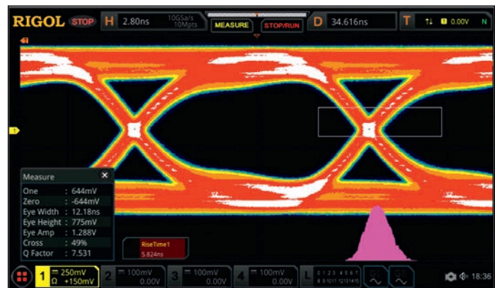
Рис. 8. Глазковая диаграмма с улучшенным таймингом
