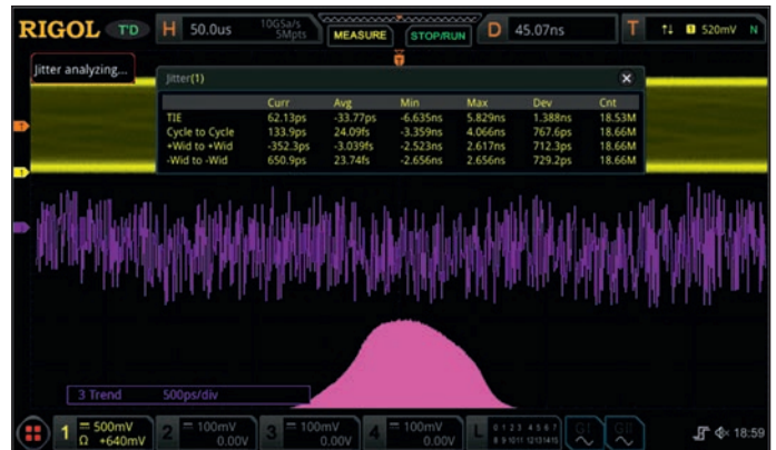
Рис. 4. Пример отображения результатов анализа джиттера на MSO8000
