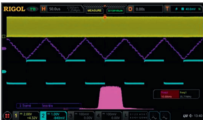
Рис. 3. Результат поиска мешающего сигнала с помощью тренда TIE и гистограммы TIE
